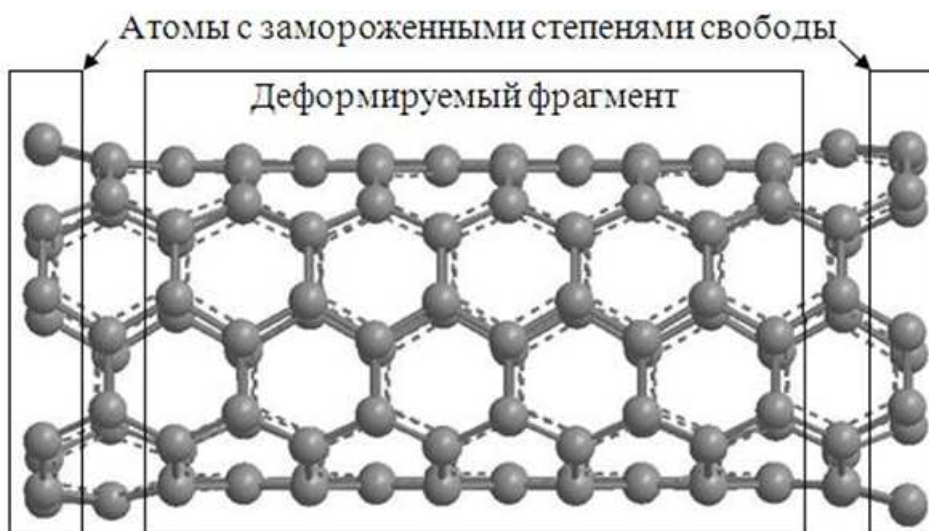
Рис. 3.3.: Схема деформирования фрагмента УНТ (5,5), использованная при моделировании поперечного сжатия
