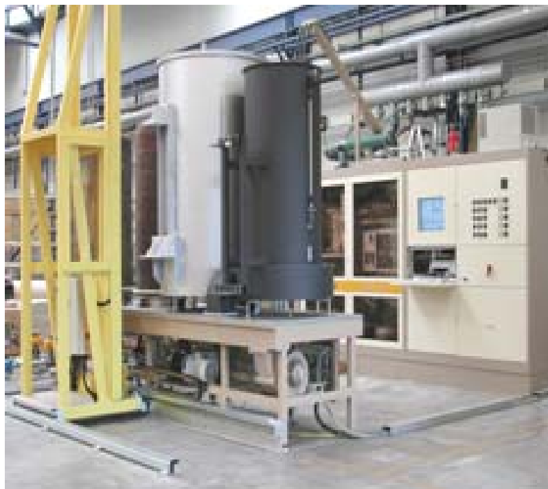
Рис. 4.4. Установка "BERNEX VPX" серии CVD
