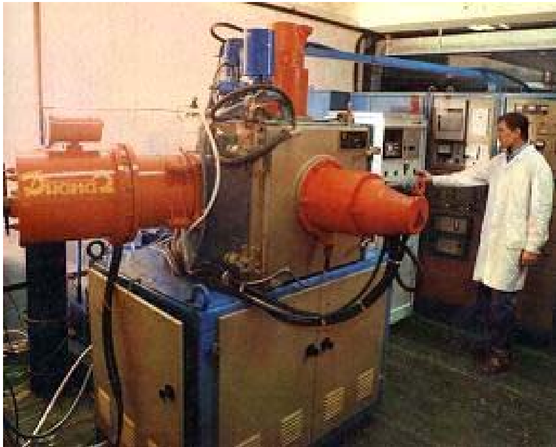
Рис. 2.10. Вакуумная установка ионно-плазменного напыления ННВ 6,6И1 с технологическим ионным имплантером «Диана-2»
