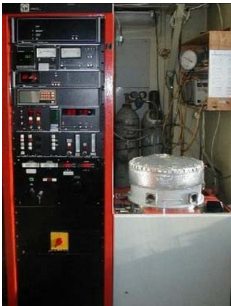
Рис. 2.4. Высоковакуумная напылительная установка Z-400 ("Leybold AG", Германия)
